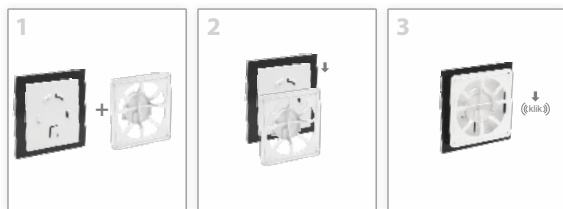
Montaż panelu na kratce (widok z tyłu) Panel installation on the grille (rear view) Montaje del panel en la rejilla (vista posterior)
